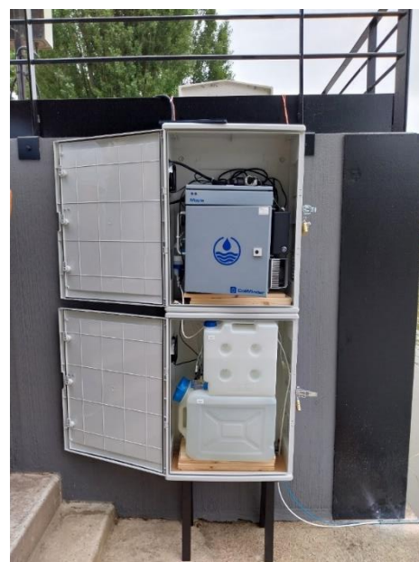
Figure 16 : Dispositif d'analyse « haute fréquence » testé en bord de Marne pendant l'été 2024
